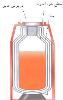
فلاسک خلأ می تواند مدت نسبتاً زیادی دمای جسم را تقریباً ثابت نگه دارد.
